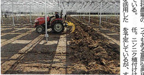
柱の設計を見直すことで、トラクタでの作業も容易になった
